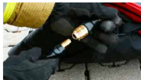
Druckluft-Kupplung; weiblich für Schlauchdurchmesser 9mm; Nennweite 7,2mm
