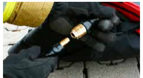
Druckluft-Kupplung: weiblich für Schlauchdurchmesser 9mm; Nennweite 7,2mm
