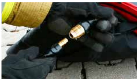
Druckluft-Kupplung: weiblich für Schlauchdurchmesser 9mm; Nennweite 7,2mm
